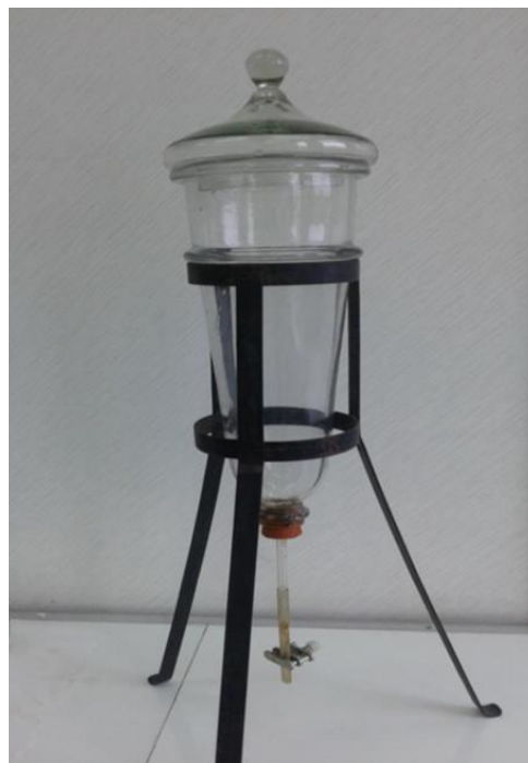
Perkolator stosowany w laboratoriach farmaceutycznych
